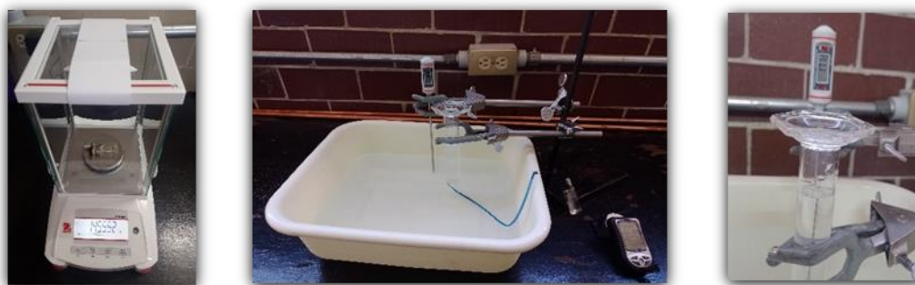
Figura 2. Fotografías que muestran de izquierda a derecha: (a) medición de la masa del encendedor; (b) montaje experimental para la recolección del volumen de gas en una probeta invertida inundada con agua a temperatura ambiental y presión atmosférica; (c) medición del volumen de gas en la probeta invertida inundada.
