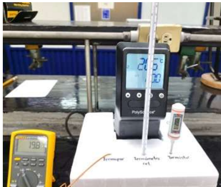
Figura 4. Fotografía que muestra el montaje experimental realizado para la condición de equilibrio térmico entre los termómetros de líquido en vidrio, termistor y termopar, con un set point de 20°C.
