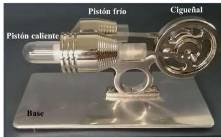
**Figura 2.** [ ] Fotografía que muestra el motor de Stirling, el cual consta de un cigüeñal y dos pistones (caliente que está en contacto con un mechero que le suministra calor a partir de la combustión de etanol y frío, que transfiere calor hacia los alrededores).
