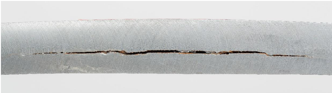
Grietas inducidas por el hidrógeno (HIC)
