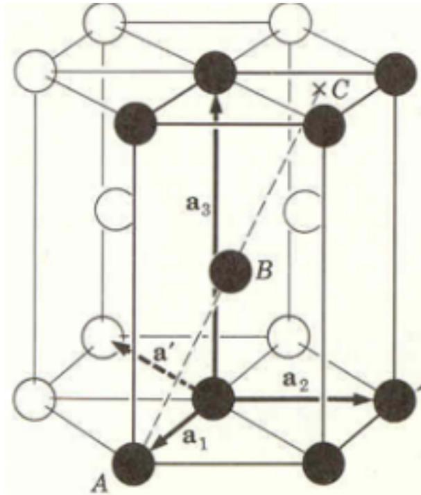
celdas vecinas. De esta forma el parámetro  $a$  está hecho por 2 radios de esfera, así pues, el radio metálico es la mitad del parámetro  $a$ .  $r = 1.335 \text{ \AA}$
