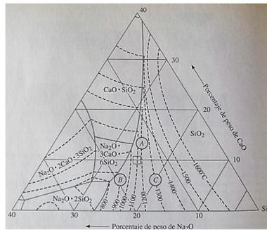
R6. B. Para el vaciado, la mezcla deberá calentarse por encima de su temperatura del liquidus y su viscosidad deberá ser suficientemente baja para que fluya fácilmente en el molde o en una placa metálica. Por lo tanto, si se requiere vaciar el líquido a 1000°C, se debe elegir una composición para el vidrio con un liquidus inferior, por ejemplo, a 900°C. Al observar las composiciones A, B y C, el vidrio B tiene un liquidus de 900°C.
