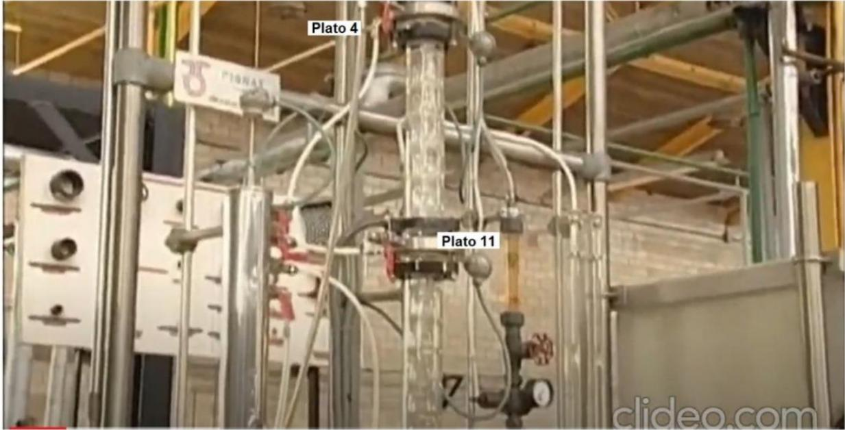
**Fotografía 2.- La torre de destilación donde se muestra la alimentación en el plato 11**
