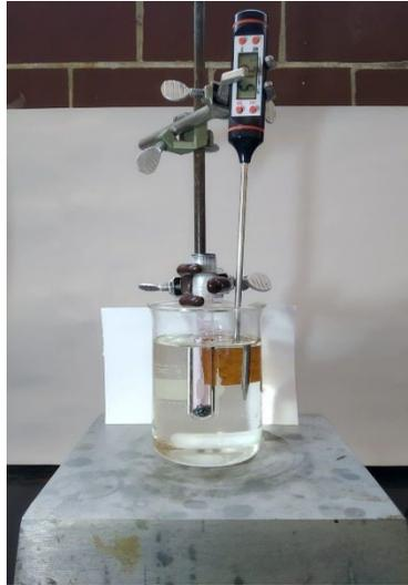
6. Comience la agitación de manera que sea suave y continua. Incremente la temperatura de la parrilla de manera que la temperatura del aceite aumente a una razón cercana a  $3\text{ }^{\circ}\text{C}/\text{min}$ .
