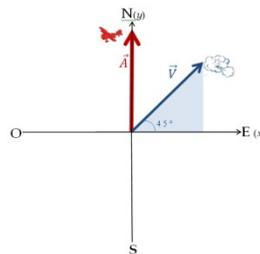
La velocidad real del avión,  $\vec{v}_R$ , es la suma:  $\vec{v}_R = \vec{A} + \vec{v}$  en donde  $\vec{A} = 0\hat{i} + 450\hat{j}$  [km/h].
