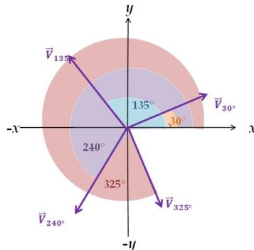
a) Observar que el cateto adyacente al ángulo señalado corresponde a la magnitud de la componente en  $x$  de  $\vec{V}_{30^\circ}$ , mientras que el cateto opuesto al ángulo señalado corresponde a la magnitud de la componente en  $y$ , entonces:
