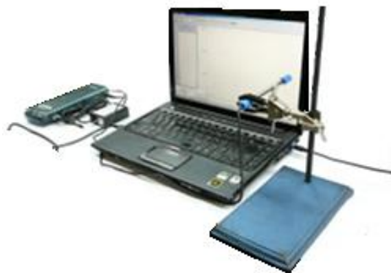
Figura 2. Se coloca el sensor de luz sobre la pantalla de la computadora, procurando evitar
