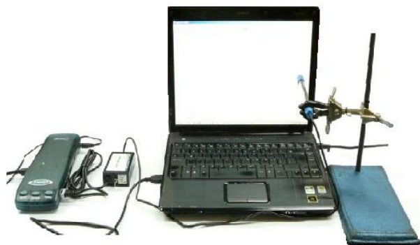
Figura 1. Arreglo experimental para efectuar las mediciones del estado de polarización de la luz proveniente de la pantalla una computadora portátil.
