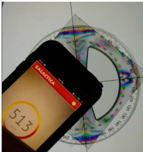
Figura 5. Uso de la aplicación de teléfono celular para medir la intensidad luminosa a 0^\circ .
