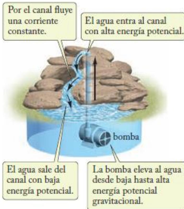
Analogía mecánica del circuito de batería y conductor de la figura anterior.
