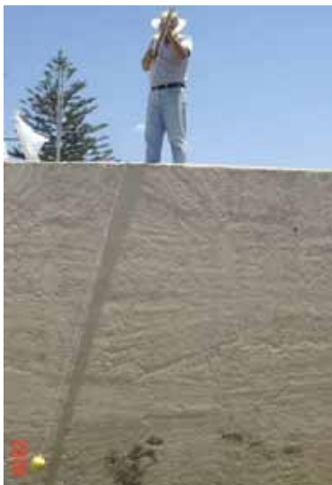
Figura 10. Péndulo de 4 m de longitud, con oscilación de 2 s de lado a lado.
