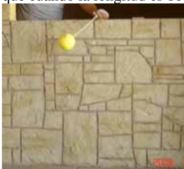
Figura 9. Péndulo de 25 cm de longitud, con oscilación de \frac{1}{2} s de lado a lado.
