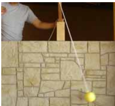
Figura 8. Péndulo de 1 m de longitud, con oscilación de 1 s de lado a lado.
