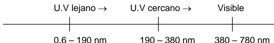
La absorción de la radiación ultravioleta o visible por moléculas, ya sean orgánicas o inorgánicas, generalmente se produce por la excitación de los electrones de enlace, por lo tanto, la longitud de onda de los máximos de absorción se puede relacionar con los enlaces de las especies absorbentes.
