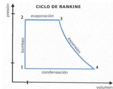
Ciclo termodinámico de los motores de vapor. La fase activa se obtiene expandiendo vapor a presión en una máquina volumétrica o continua.
