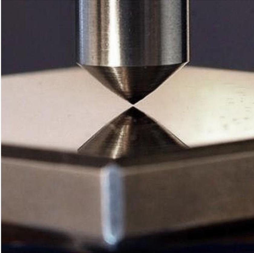
La **dureza**, desde el punto de vista **metalúrgico**, es la **resistencia** que presenta un material a la **deformación plástica** causada por la penetración de un **indentador** bajo la acción de una **carga**, es decir, la facilidad o dificultad en que se genere una huella permanente en la superficie del material.
