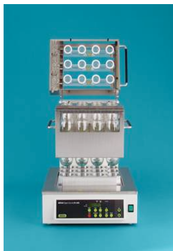
Figura 2. Bloque de digestión Kjeldahl A) Unidad de digestión con parrilla de calentamiento para 20 unidades y panel digital, B) Unidad de extracción y neutralización de vapores ácidos de la reacción Kjeldahl.
