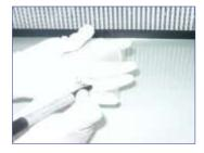
2. Abrir la placa Compact Dry depositar 1mL. de la muestra sobre la parte central del compact dry
